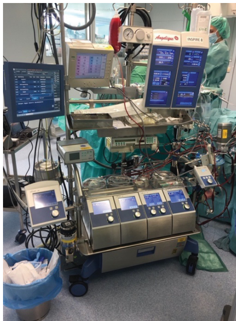
Abb. 1: Herzlungenmaschine Typ Stöckert S5 (Quelle: eigenes Material)
